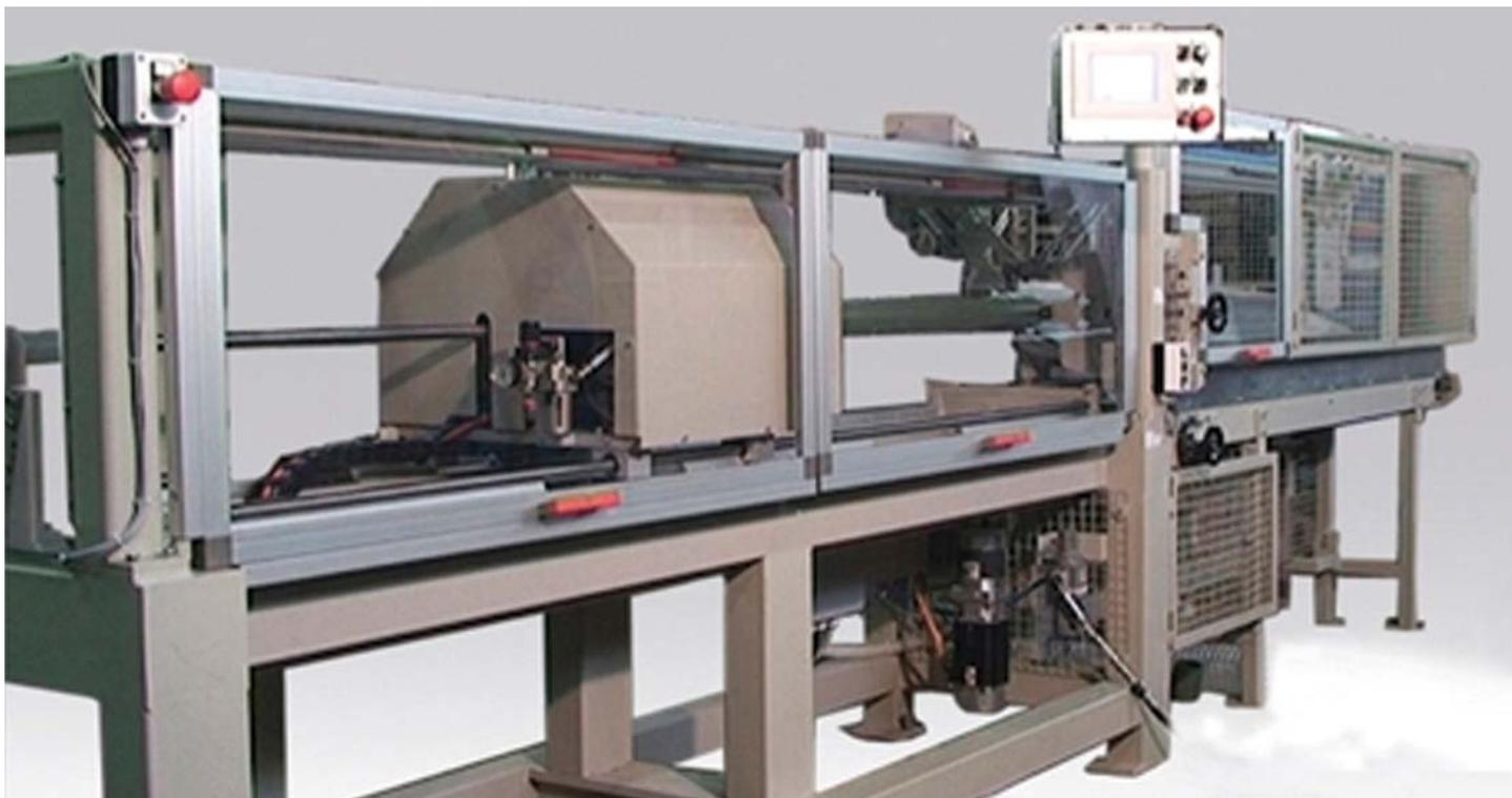
Macchina automatica per il taglio di tubi di cartone, PP e PVC da 70 a 152 mm e spessore da 6 a 20 mm. Lunghezza tubi in origine 3000 mm.
